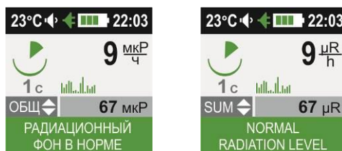
Рисунок 6 – Вид экрана в режиме измерения
