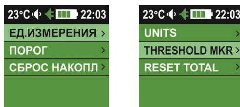
Рисунок 8 – Установка параметров измерения
