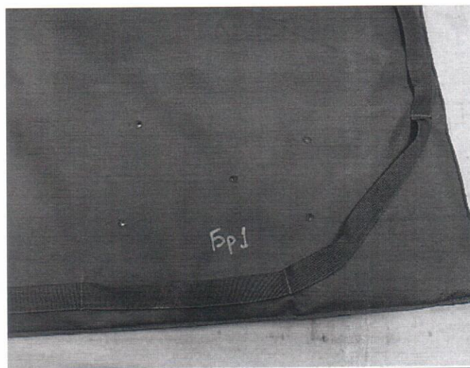
Рис.1 Внешний вид маркировки и испытанных образцов ПРОТОВООСКОЛОЧНЫХ ОДЕЯЛ после испытаний
